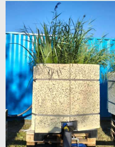
2 IBC Tanks mit je 1 m 3 im Parallelbetrieb
