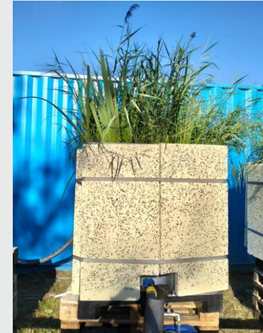
2 IBC Tanks mit je 1 m 3 im Parallelbetrieb
